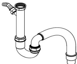
**Sifon mit flexiblem Abgang und GS-Anschluss**
